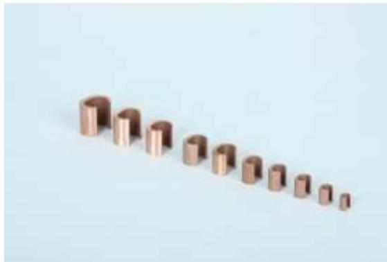
Se utiliza para conectar cable-cable ó jabalina- cable utilizando una herramienta hidráulica que comprime la unión a una presión de 12 Ton/cm2. Dicha compresión realiza una unión muy segura donde el material se deforma elásticamente mezclándose al punto que a la vista parece fundido, por lo que se lo suele llamar también como fusión en frío.
